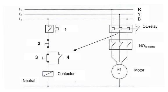
FIGURE 10.2: DIRECT-ON-LINE MOTOR STARTER
